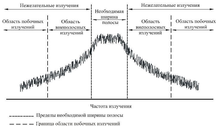
РИСУНОК 1 (ВКР-03) Области внеполосных и побочных излучений
