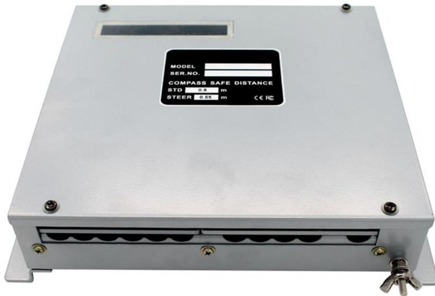
Общий вид порт-интерфейса BAS-28– дистрибьютор NMEA сигнала 15 выходных портов
