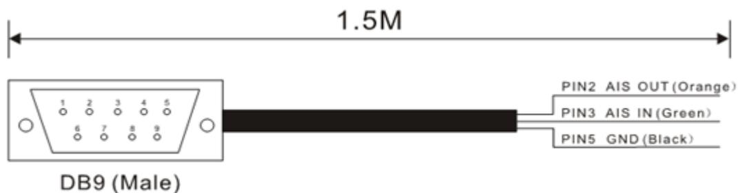
Чертеж кабеля данных для подключения другого навигационного оборудования
