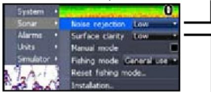
**Чистота поверхности:** убирает помехи около поверхности воды (только для расширенного режима)
