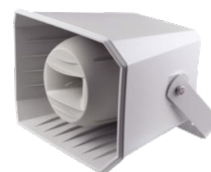
LS-9/100 Громкоговоритель рупорный, двухполосный, IP66, 25/50 Вт, 100 В.
