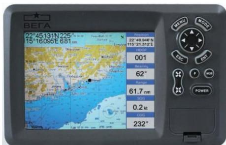
Отличительной особенностью указанных моделей является возможность передачи данных о местоположении судов, получаемых от низкоорбитальных космических спутниковых систем, в центр мониторинга судов в автоматическом режиме.
