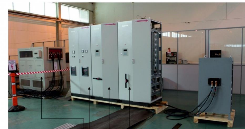
Трансформатор преобразовательный 1 Выпрямитель двенадцатипульсный 2 Инвертор трехфазный 3 Резистор тормозной 4
