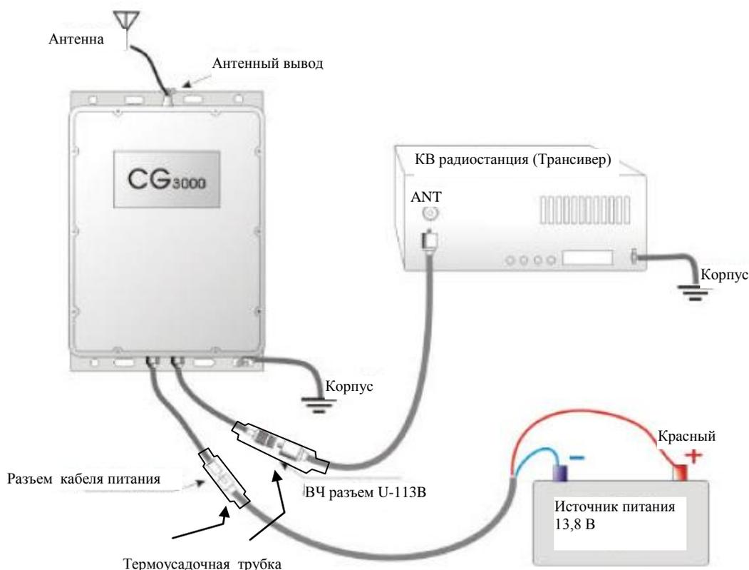
После выполнения всех монтажно-соединительных работ (подключений) установите рабочую частоту на приёмопередатчике и необходимый режим работы.
