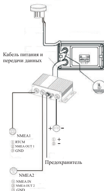
Схема подключения при помощи 8-контактного разъема DSUB
