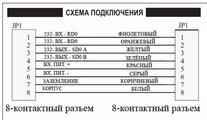
Схема подключения при помощи 8-контактного разъема DSUB
