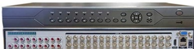
Рисунок А.10 – Внешний вид видеорегистратора ИВМ-8032.
